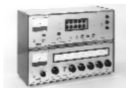
4. ábra Digitális kiegyenlítésű automatikus áramváltó hitelesítő berendezés. A VBKM Transzvill gyárában több száz ezer áramváltó hitelesítését és bizonylatolását végezte el.
